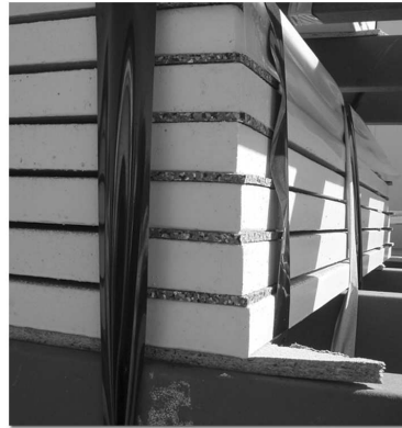
Antirutschmatten zwischen den mineralit ® -Platten
