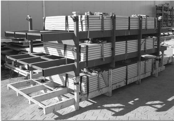
In Stahlleihpaletten verpackte mineralit ® -Platten
