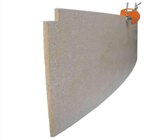
So ist es möglich in die dritte Dimension zu bauen und runde Fassaden nachhaltig zu verkleiden. Optimal eignen sich für die Montage Keil - Hinterschnittanker die beim Herstellungsvorgang direkt mit eingegossen werden.
