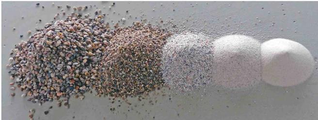
**Werkstofftechnisch** betrachtet ist Mineralguss eine hochgefüllte Kunststoffverbindung, die aus einer Verbindung zwischen kalthärtendem Reaktionsharz und Zuschlagstoffen besteht, die entweder einen rein mineralischen Charakter (z.B.
