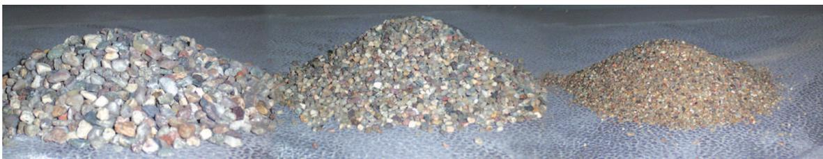
*Mineralit ist ein Hochleistungs Verbundwerkstoff, der zu 94 % aus natürlichen Quarzsanden besteht (s. Bild), die mit einem hochwertigen, selbstvernetzenden Acrylharz gebunden werden. Aus diesem Material werden hochverschleißfeste Formelemente gegossen.*
