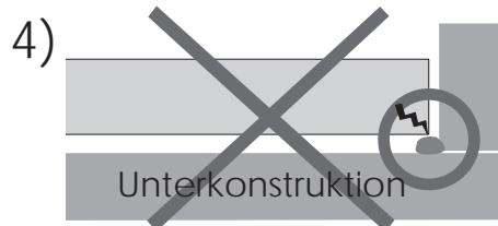
Die maximale Verformung der Unterkonstruktion darf nicht größer als zulässig sein ( $L/300$ ).
