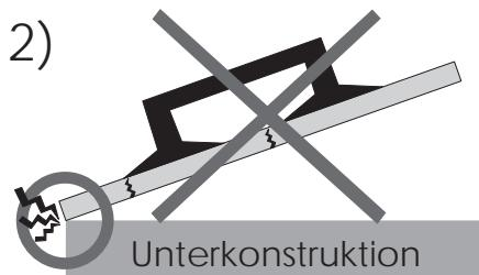
Die Platte muß unbedingt sorgfältig waagerecht abgesetzt werden. Das Aufsetzen einer einzelnen Kante oder Ecke führt zwangsläufig (aufgrund statischer Überbelastung) zur Rißbildung in der Platte.
