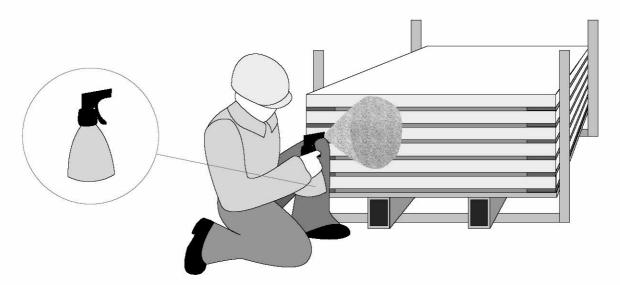
Durch Anfeuchten mit Wasser (z.B. mit einer handelsüblichen Wassersprühflasche) zeichnen sich eventuelle Risse noch deutlicher ab.
