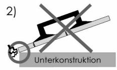
Die Platte muß unbedingt sorgfältig waagerecht abgesetzt werden. Das Aufsetzen einer einzelnen Kante oder Ecke führt zwangsläufig (aufgrund statischer Überbelastung) zur Rißbildung in der Platte.
