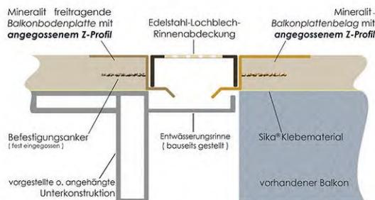
Um zum einen eine optimale **barrierefreie Verbindung** zwischen dem vorhandenen Balkonbelag und der erweiterten freitragenden Balkonplatte herzustellen und zum anderen umso das Wasser optimal mittig der Balkonkonstruktion abführen zu können.
