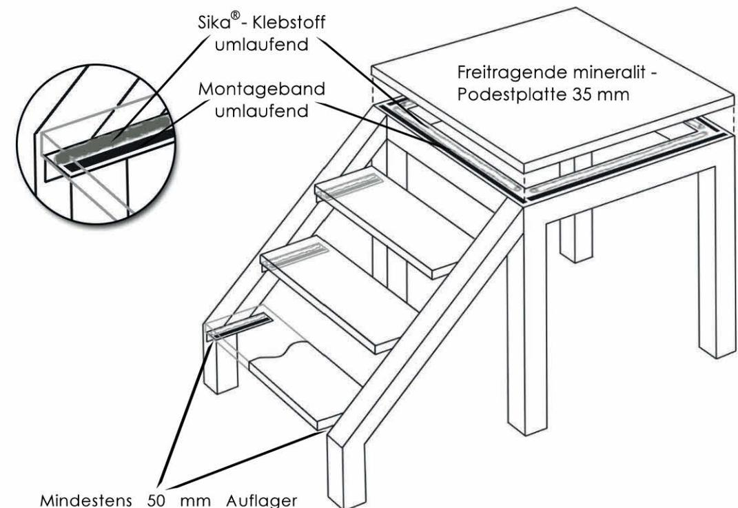
Mindestens 50 mm Auflager auf beiden Seiten der Stufe, Länge gemäß Stufenbreite, Stufen müssen bündig mit der Unterkonstruktion abschließen.
