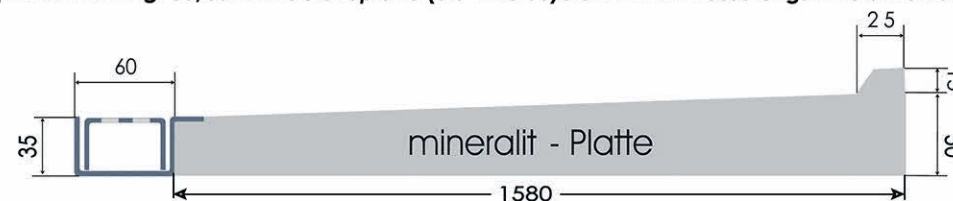
Beispieldarstellung: 35/50 mm Gefälleplatte (als Einfeldsystem mit Entwässerungsrinne & Aufkantung)
