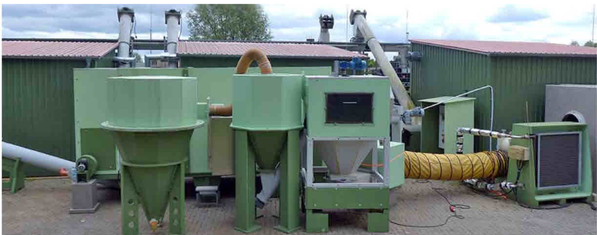
links: Wirbelschichttrocknermodul Innenaufbau unten: Wirbelschichttrockner an Versuchsanlage
