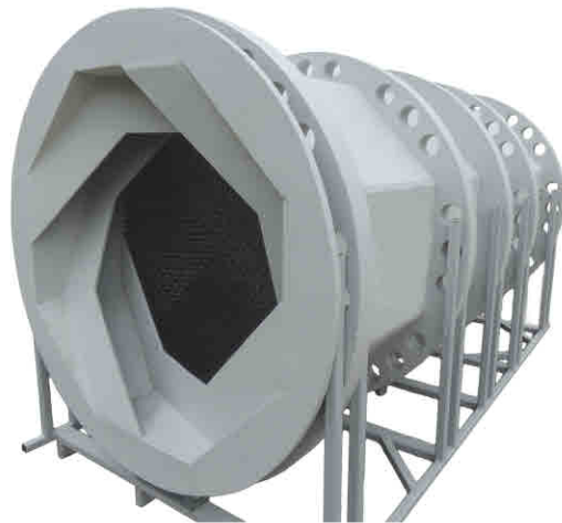
mineralit ® - Trommel in Compoundkernbauweise
