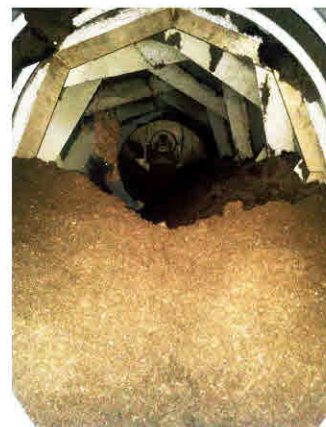
unter Extrembedingungen: mit Gärresten überfüllte mineralit® - Trommel
